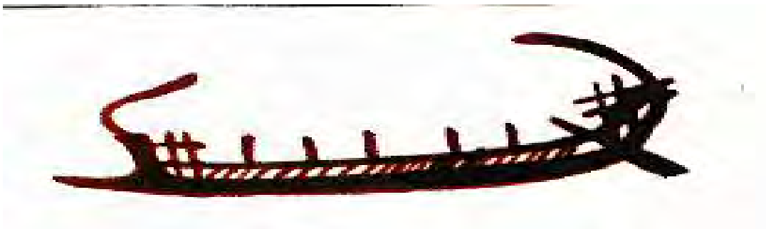
Fig.70. Gresk skipstype fra Middelhavet 1200 år før Kristus. Skipet har rambukk foran og for- og akterstavn svinger innover.
