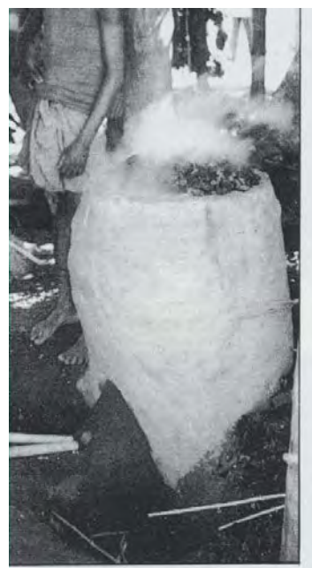
Fig. XVII Ovn i drift for direkte reduksjon 1960 Asur jernutvinnere, Bihar, India.
